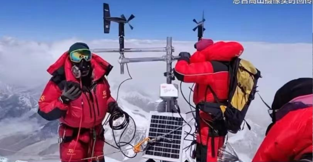
8800米! 全球海拔最高自动气象站正在架设
